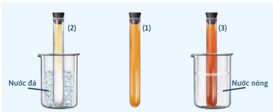
Hình 1.2. Ảnh hưởng của nhiệt độ đến chuyển dịch cân bằng 2\text{NO}_2 \rightleftharpoons \text{N}_2\text{O}_4
